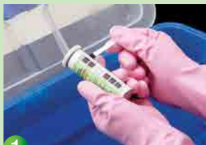
1 С помощью Асесайд тест-полосок перед использованием рабочего раствора АСЕСАЙД убедитесь в том, что концентрация надуксусной кислоты превышает минимальную эффективную концентрацию (0,2%). Необходимый уровень дезинфекции не достигается в случае недостаточного перемешивания. Тщательно перемешайте раствор с помощью стеклянной палочки после добавления Реагента 1 или перед использованием рабочего раствора.
