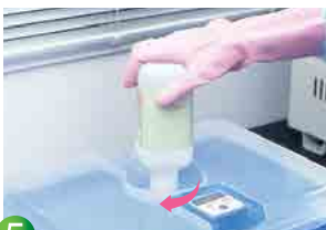
5 Поверните контейнер с Реагентом 1 по часовой стрелке и влейте Реагент 1 в лоток для замачивания.
