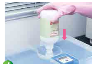
4 После отсоединения коробки для дезодоранта вставьте контейнер с Реагентом 1 (500 мл) колпачком в отверстие в центре крышки.
