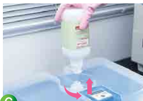
6 Удалите флакон из-под Реагента 1, повернув его против часовой стрелки. Во время операции соблюдайте осторожность, избегая попадания капель раствора на окружающие предметы.
