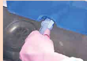
Присоедините шланг к сливному выступу лотка и надежно закрепите коннектор шланга в фиксирующих пазах. Поверните коннектор шланга по часовой стрелке и слейте раствор, разбавляя его большим количеством воды. (Примечание) Слив раствора начинается непосредственно после присоединения коннектора к сливному отверстию.
