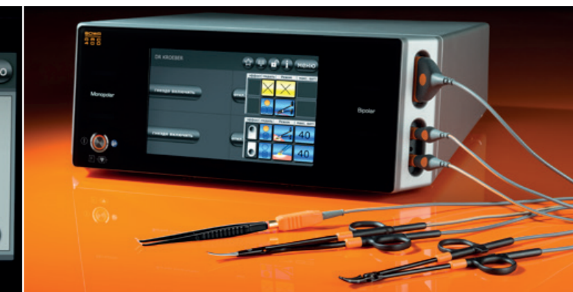
Эффективность: при монополярной коагуляции можно активировать два инструмента одновременно
