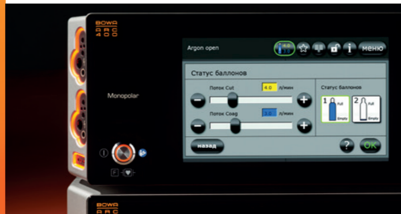
Логичный и простой пользовательский интерфейс позволяет легко и быстро регулировать любые параметры аргона
