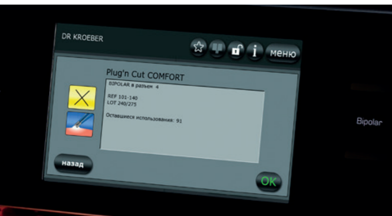
Plug'n Cut COMFORT: система COMFORT автоматически распознает инструмент COMFORT, информирует о количестве применений и выбирает параметры, необходимые для цели применения
