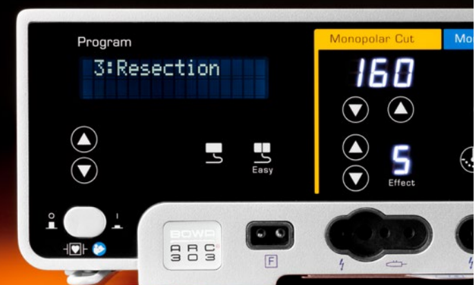
Программа Resection позволяет увеличить мощность до 300 Вт для вапоризации с помощью монополярных резектоскопов
