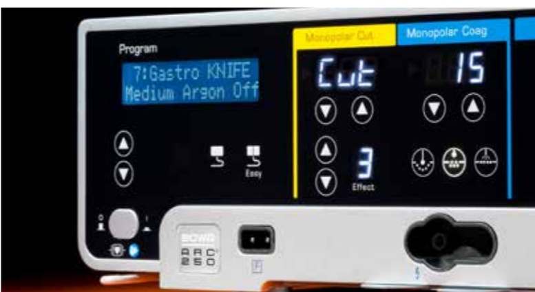
Функция GastroCut KNIFE предназначена для рассечения с помощью папиллотомы или электродами-иглами
