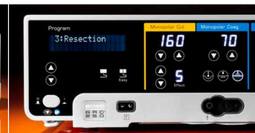
Программа резекции Resection предлагает предварительную настройку для использования монополярных резектоскопов или гистероскопов до макс. 250 Вт.
