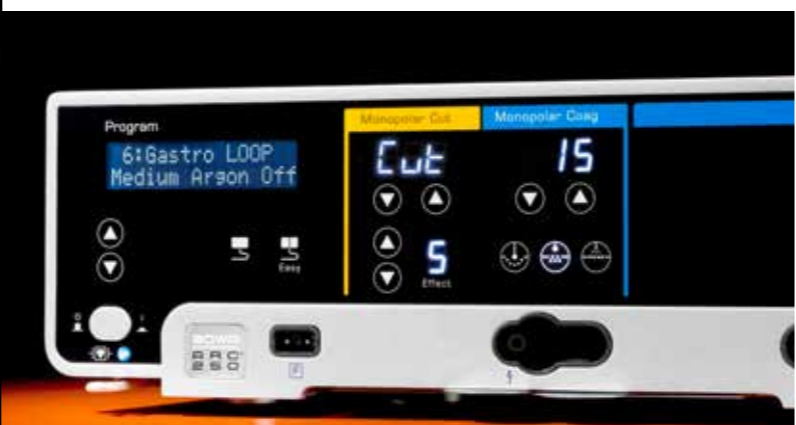
Функция GastroCut LOOP предназначена для резекции с использованием электродов-петель
